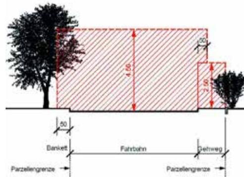
Die schraffierte Fläche ist von überhängenden Ästen und Sträuchern freizuhalten. Die Höhe des Lichtraums beträgt 4,50 m über Verkehrsflächen, die für den Fahrverkehr bestimmt sind, und 2,50 m über Verkehrsflächen, die nicht für den Fahrverkehr bestimmt sind.
