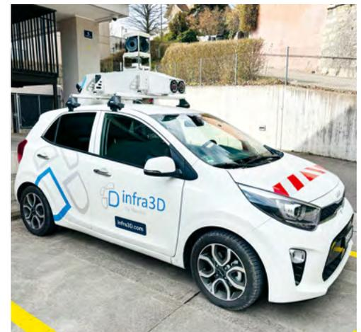
Mit einem speziellen Messfahrzeug entsteht ein präzises dreidimensionales Abbild der Strassenräume.
