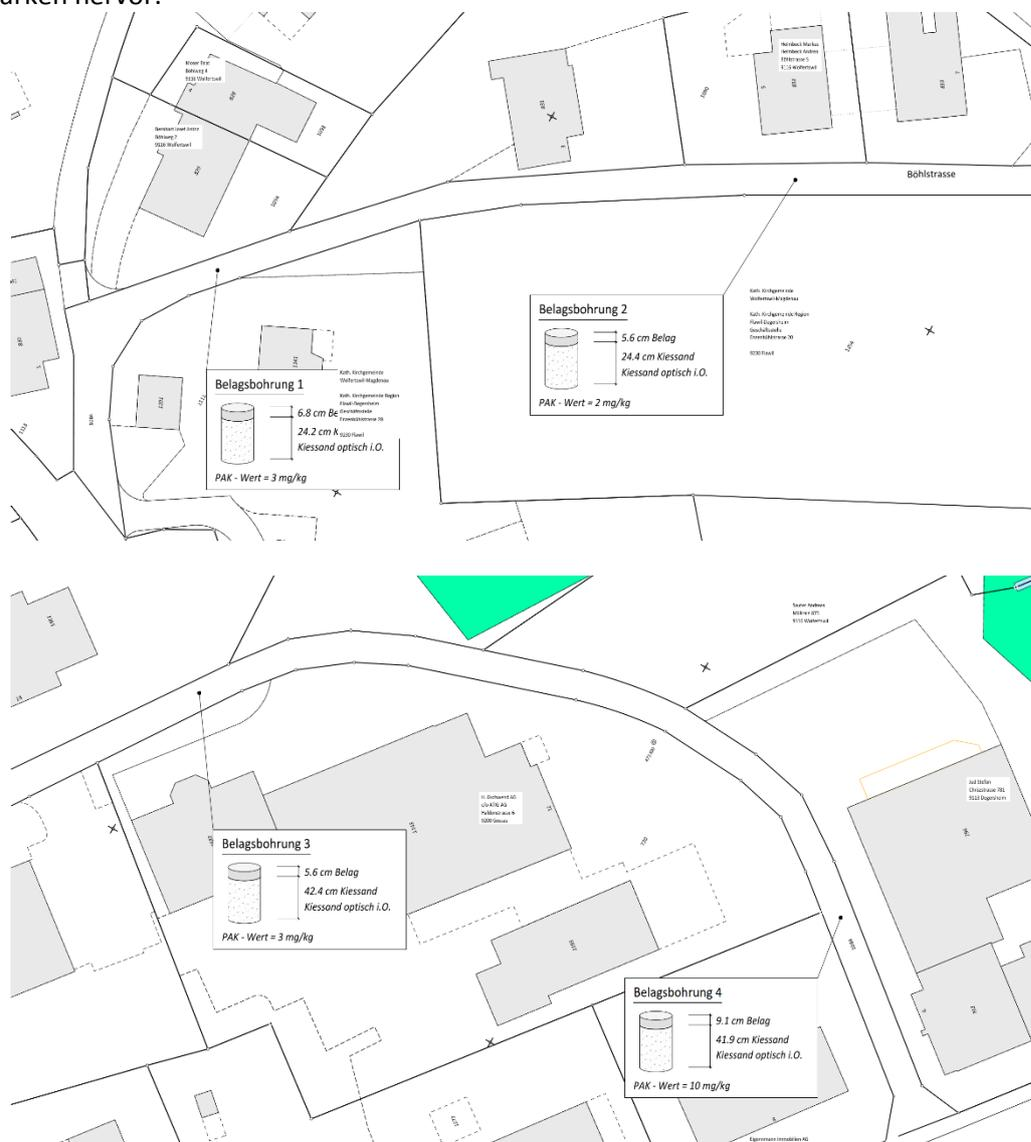
Für sämtliche Bohrungen wurden PAK Untersuchungen durchgeführt. Aus den Untersuchungen ergab sich kein zu hoher PAK Wert. (PAK-Wert < 250 mg / kg Asphalt)
