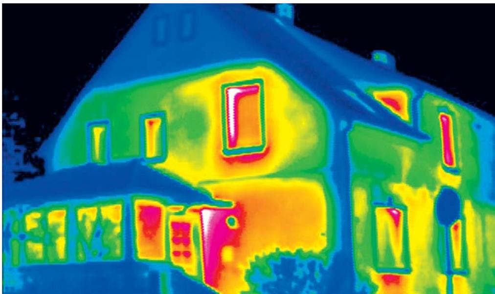
Eine Thermografie bringt die Schwachstellen eines Gebäudes ans Licht. Bei den roten Stellen sind die Wärmeverluste am grössten.
