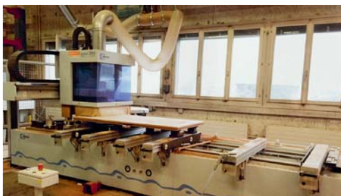
Mit der neuen CNC-Maschine kann die KHG Spornberger-Gruppe auch komplexe Holzteile einfach und günstig anfertigen.
